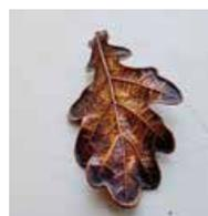
**3.** Создание автоматизированного оборудования и специальных электролитов дало возможность гальванопластического формирования изделий из сплавов золота 16 и 18 карат. До недавнего времени гальванопластические изделия изготавливались из осадков чистого золота.
