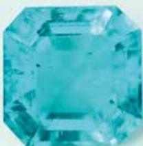
Рис. 7. Субпараллельные неоднородные структуры роста в синтетическом гидротермальном синем берилле производства России.
